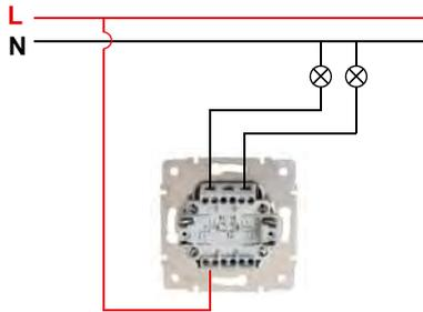
Schemat oprzewodowania | Wiring Diagram
