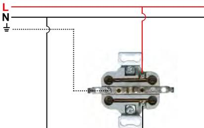
Schemat oprzewodowania | Wiring Diagram
