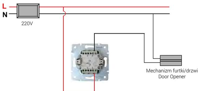
Schemat oprzewodowania | Wiring Diagram
