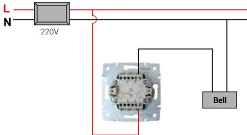
Schemat oprzewodowania | Wiring Diagram
