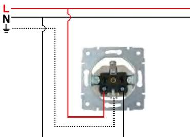
Schemat oprzewodowania | Wiring Diagram
