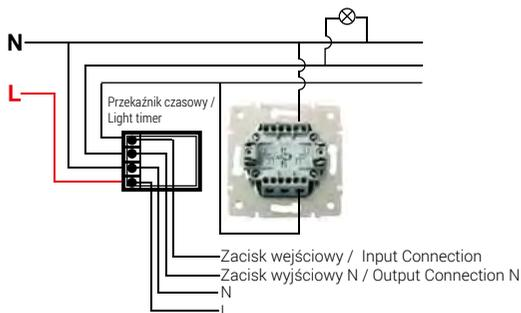
Przykładowy schemat oprzewodowania | Wiring Diagram (exemplar)
