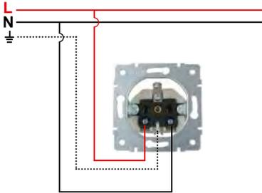
Schemat oprzewodowania | Wiring Diagram
