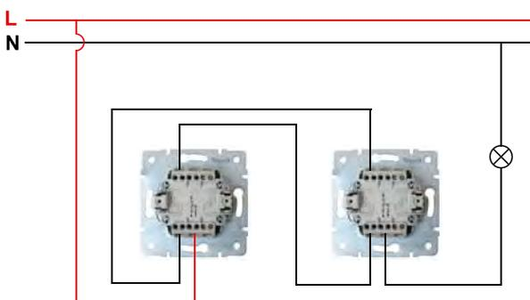
Schemat oprzewodowania | Wiring Diagram
