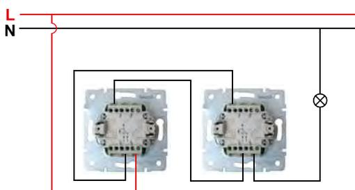
Schemat oprzewodowania | Wiring Diagram
