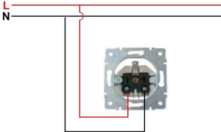
Schemat oprzewodowania | Wiring Diagram
